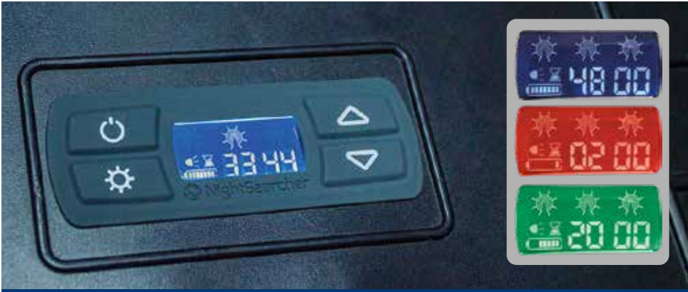
LCD programlanabilir ekran: Işık modu seçimi • Program çalışma süresi 48 saate kadar • Renk bazlı pil durumu
